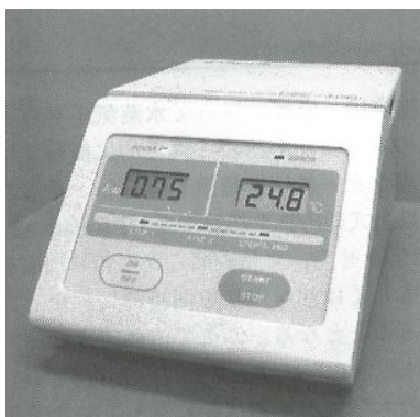
電気抵抗式湿度センサー水分活性測定器(当社製 EZ-100)
