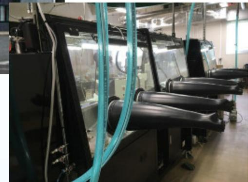
次世代全固体二次電池試作設備
