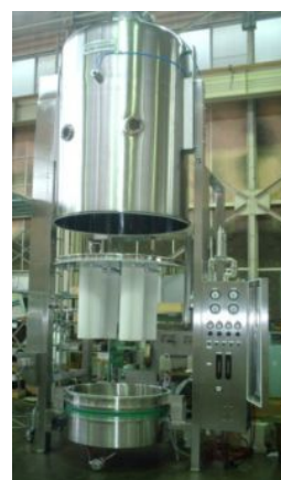
カートリッジフィルター仕様の 流動層装置
